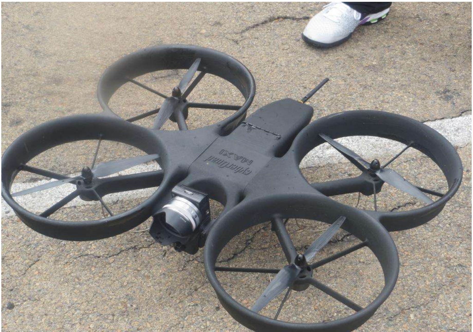
カメラとデータリンク装置の装着状態
