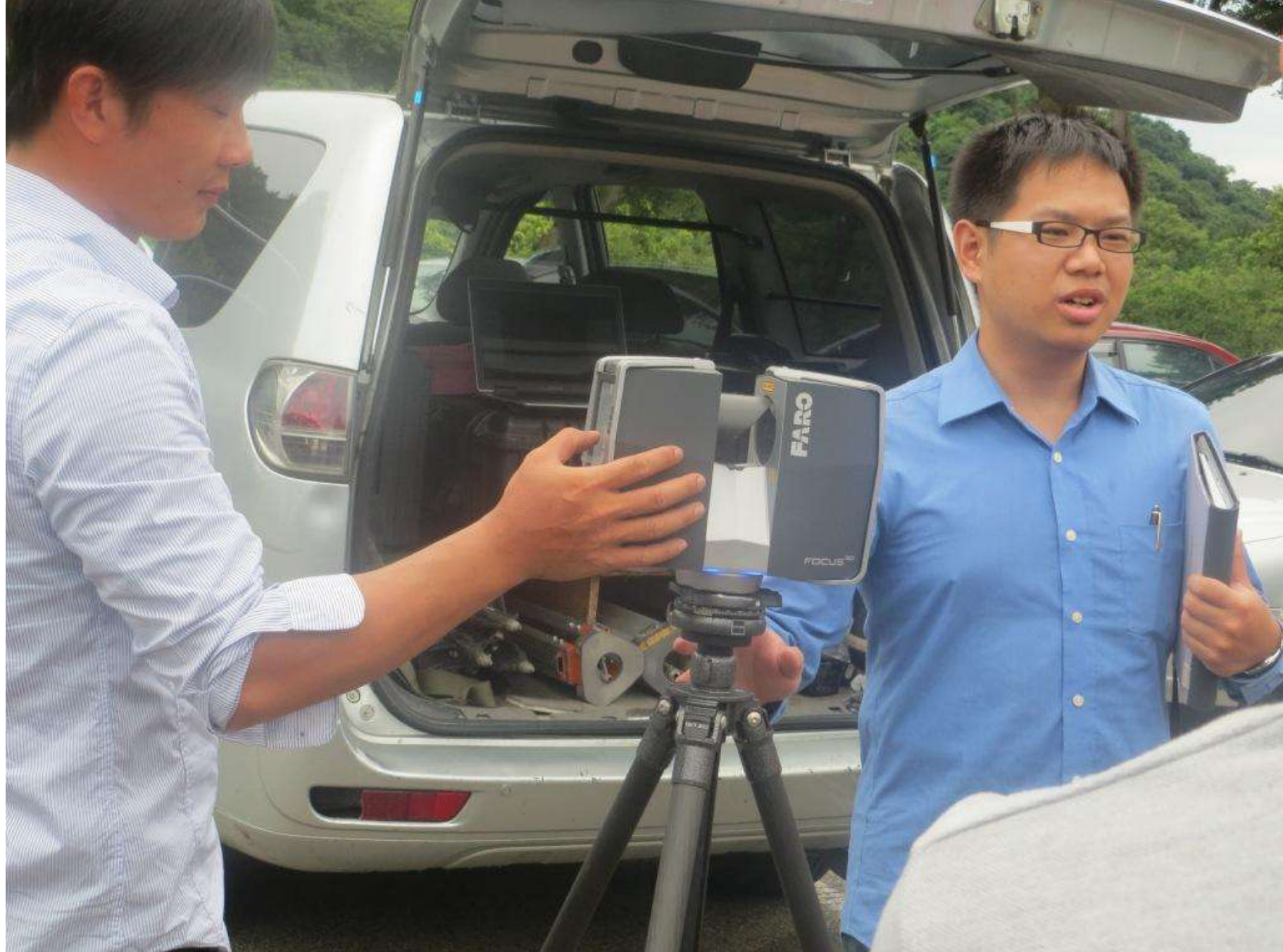
3Dレーザ測定器(中央の円形ミラーが高速回転)
