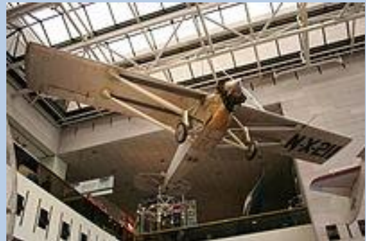
スピリット・オブ・セントルイス号 (ライアンNYP-1: 鋼管羽布張)
