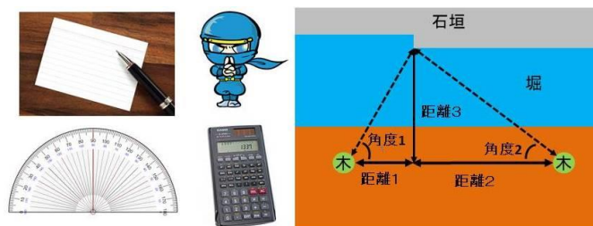
三角測量で堀の幅を計る
