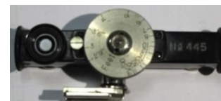
距離計の接眼部 (左) とダイヤル
